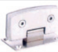
Modelo N° SG-532 (90°) Material: Steel 202 o 304 Acabado: SSS o PSS Espesor Vidrio: 6 - 12 mm
